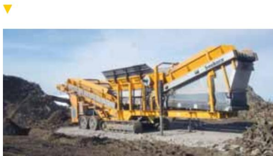
Criblage du matériel racinaire, grain surdimensionné 150 x 250/300 mm
