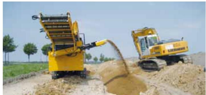
Utilisation dans la construction de canalisations avec remplissage direct des grains fins
