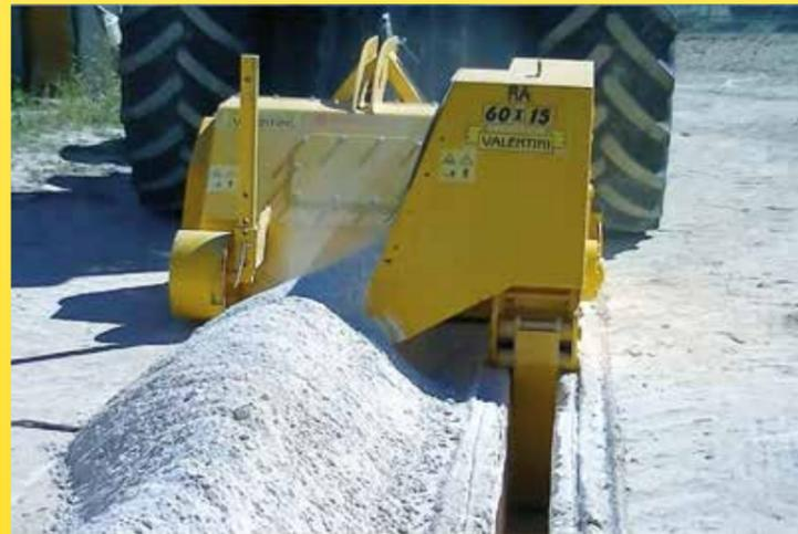
La trancheuse VALENTINI RA400-900 est conçue pour descendre jusqu'à 90 cm dans le sol, elle existe en différentes largeurs de travail de 100 à 400 mm, elle s'adapte sur des tracteurs de 70 à 250 CV. Son poids va de 760 à 4200 kg suivant le modèle.
