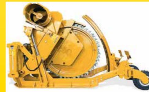
La trancheuse VALENTINI RA1200-1500 est conçue pour descendre jusqu'à 145 cm dans le sol, elle existe en différentes largeurs de travail de 400 à 500 mm, elle s'adapte sur des tracteurs de 300 à 400 CV. Son poids va de 4000 à 7200 kg.
