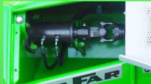
Le corps de la machine est réalisé sous la forme d'un monolithe spatial soudé avec des éléments à deux couches dans la zone de fonctionnement du rotor. Des aciers de construction à résistance accrue ont été utilisés pour la construction, notamment STRENX et HARDOX. L'ensemble du système d'entraînement et hydraulique est situé à l'intérieur du châssis.
