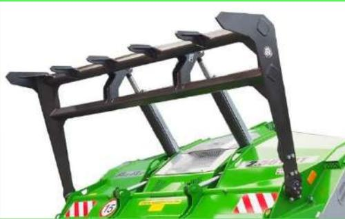
Le rabatteur de branches permet de déchiqeter en toute sécurité les buissons ainsi que les arbres debout d'une épaisseur considérable. Le rabatteur arrière standard dispose d'un réglage manuel de l'angle à plusieurs plages. En option supplémentaire, les clients choisissent souvent un rabatteur commandé par des vérins hydrauliques. Les dents de guidage en option sur la poutre supérieure du rabatteur sont recommandées pour les machines fonctionnant dans des sous-bois denses.
