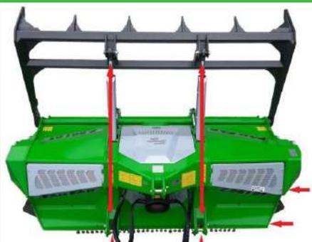
Les coins avant et arrière de la machine ont des éléments diagonaux « profilés ». Lorsque vous travaillez dans des broussailles denses, les arbres et buissons sur pied sont poussés sur les côtés plutôt que d'être attrapés et tirés par les parties saillantes de la machine.
