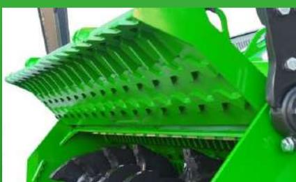
Un grand capot arrière à deux couches, commandé par des vérins hydrauliques, permet de réguler le degré de fragmentation du matériau. Des peignes HARDOX supplémentaires améliorent la fragmentation et protègent la couverture contre l'abrasion.
