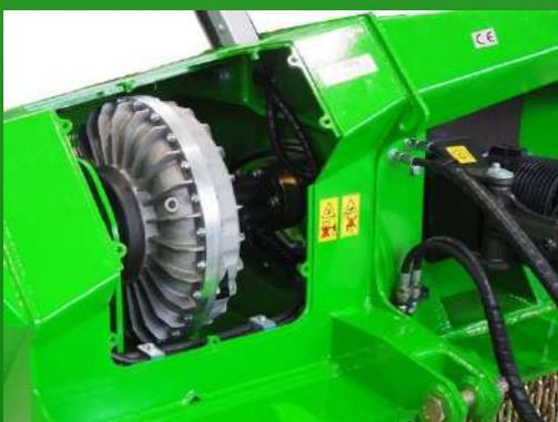
Les embrayages hydrocinétiques transmettent un couple élevé et protègent en même temps le système d'entraînement de la machine et du tracteur contre les surcharges. Ils facilitent considérablement le travail de l'opérateur dans toutes les conditions.
