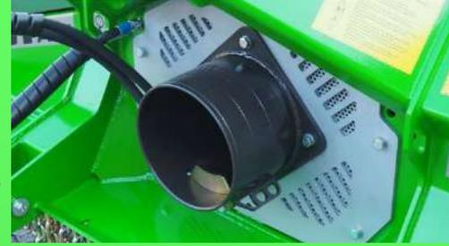
Le capot avant et le manchon protégeant l'embrayage de la prise de force sont en matériau de 8 mm d'épaisseur et protègent efficacement les composants de l'entraînement et du système hydraulique.
