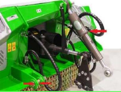
Attelage Cat 3, goupilles trempées de 32 mm de diamètre montées dans des douilles HARDOX massives de 28 mm. Un carter d'engrenage en acier et des couvercles étanches et solides protègent le système d'entraînement contre la pénétration du bois et du sol.
