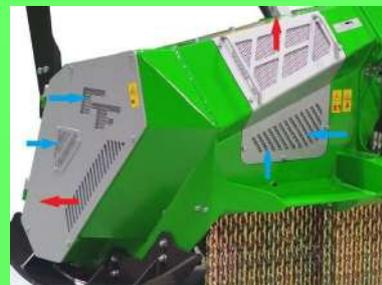
Le bloc d'entraînement est conçu pour transmettre 250 CV pour les modèles de la série 53 et 320 CV pour les modèles de la série 61. Équipé d'un système de graissage centralisé forcé et de refroidissement d'huile pour les engrenages et les arbres de transmission. Dans l'option avec pompe, l'huile est nettoyée par un filtre à passage intégral.
