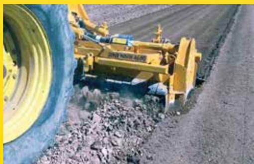
Le broyeur SUPER PREDATOR est conçu pour descendre jusqu'à 15 cm dans le sol, sa largeur de travail est de 4290 mm, il s'adapte sur des tracteurs de 250 à 350 CV. Son poids varie de 4500 à 5200 kg suivant les options.
