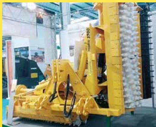
Le broyeur PREDATOR est conçu pour descendre jusqu'à 15 cm dans le sol, il existe en différentes largeurs de travail de 3200 à 3700 mm, il s'adapte sur des tracteurs de 200 à 260 CV. Son poids varie de 3050 à 4150 kg.
