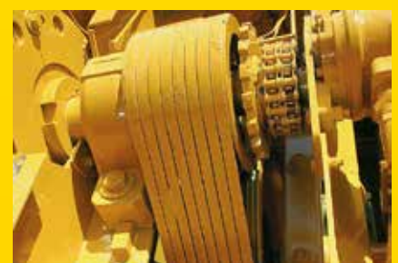
Transmission par courroies Kevlar hautes performances
