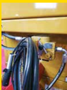
Débitmètre hydraulique pour le contrôle manuel de la vitesse d'avancement du bol et de la charge du tracteur
