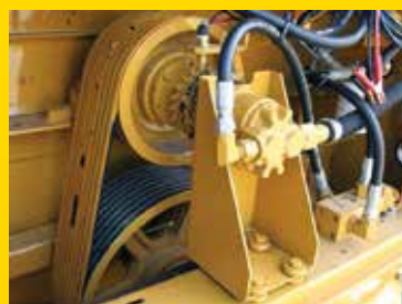
Pompe hydraulique entraînée par des courroies Kevlar hautes performances
