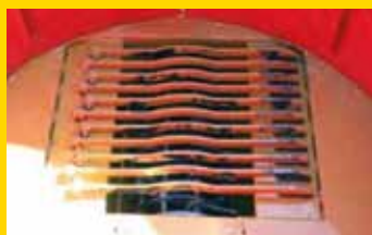
Barreaudage sur rotor réglable par positionnement du levier
