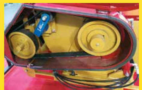
Transmission directe sur le souffleur et le rotor par courroies trapézoïdales
