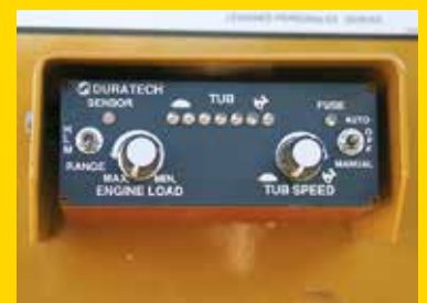
Régulateur de vitesse électronique Duratech protégeant le broyeur et le tracteur
