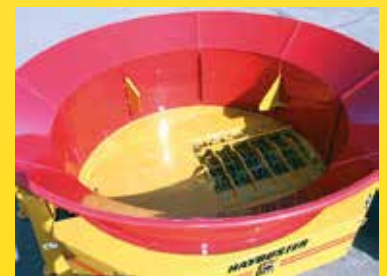
Intérieur du bol avec barreaudage sur rotor
