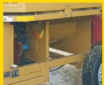
Système de réglage du barreaudage sur rotor par positionnement du levier
