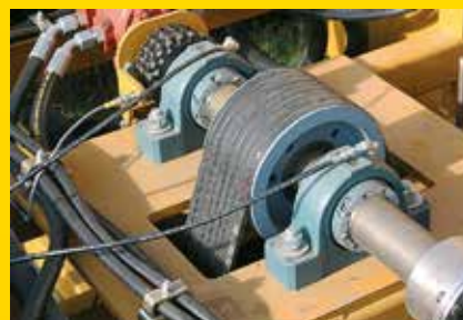
Transmission par courroies Kevlar hautes performances
