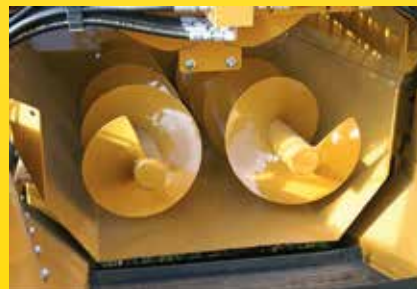
Double vis sous rotor d'évacuation des broyats
