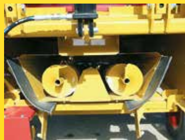
Double vis d'évacuation des broyats
