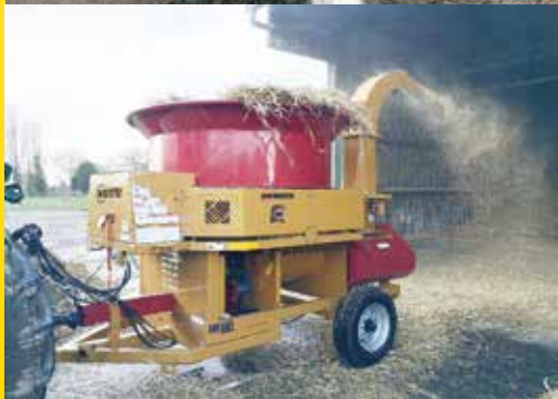
Chambre de broyage avec grille interchangeable de 10 à 150 mm et vis d'évacuation des broyats
