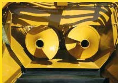
Double vis d'évacuation des broyats
