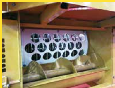
Chambre de broyage avec grille interchangeable de 10 à 150 mm et vis d'évacuation des broyats
