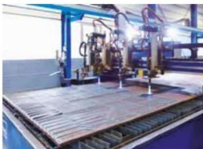
Machine de découpe par oxycoupage CNC
