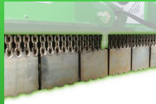
Ecran renforcé avec plaques en acier
