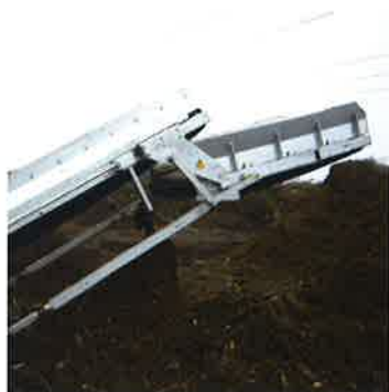
bande de séparation des pierres sur le convoyeur arrière
