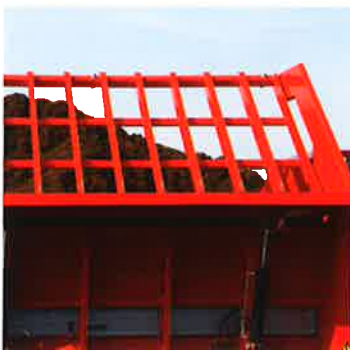
grille de scalpage sur trémie
