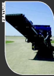
Convoyeur AR pivotant +/- 40°
