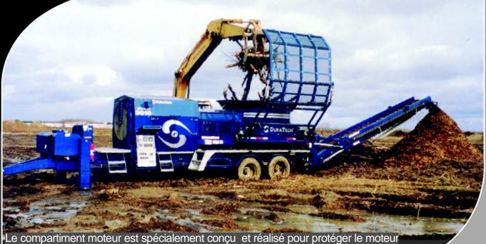
Le compartiment moteur est spécialement conçu et réalisé pour protéger le moteur de la poussière et des matériaux. La casquette optionnelle contrôle les projections.
