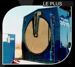
La grille rotative à nettoyage automatique dispose d'une surface de passage d'air de 1,162 m² Arrivée d'air frais et propre en permanence sur le moteur et le radiateur Entretien réduit et offre la souplesse pour positionner le broyeur
