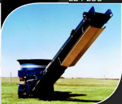
Convoyeur AR largeur 762 mm Longueur 7920 mm Hauteur de rejet 5480 mm / sol Rouleau magnétique optionnel avec toboggan aluminium pour la séparation des ferreux dans un conteneur Pivotement sur 50°
