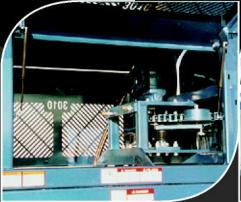
Entraînement de bol par 1 seul moteur hydraulique Régulateur électronique d'alimentation du broyeur Chaîne type 120H robuste Tension de chaîne par ressort Pignon en continu tout autour du bol
