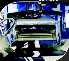
Convoyeur sous bol de 762 mm de largeur sans jonction Bande résistante aux impacts vulcanisée à chaud
