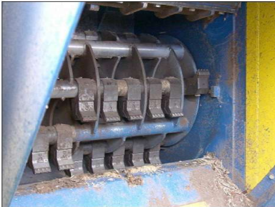
HFG V: Unité de broyage avec et sans grilles
