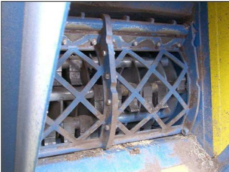
HFG V: Unité de broyage avec et sans grilles
